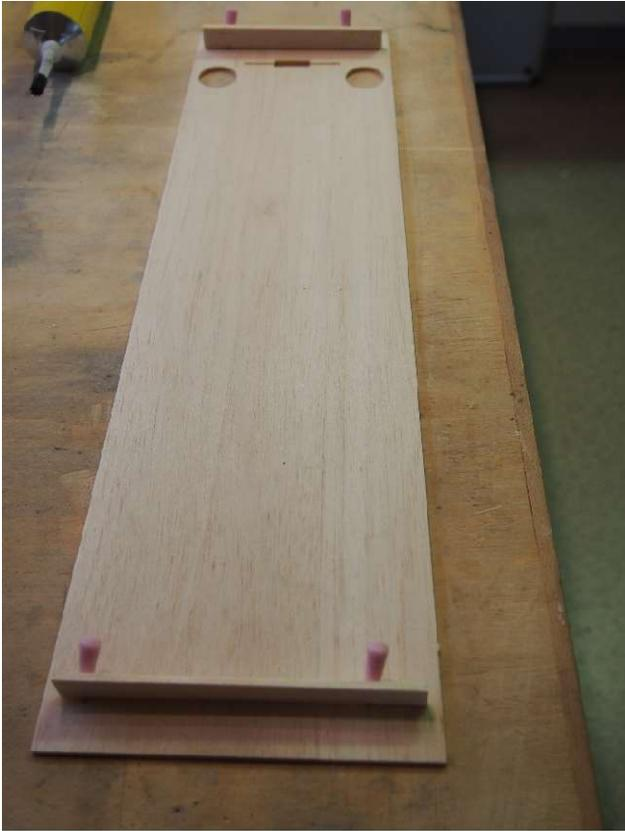
Bildfolge Aufbau Flügel 4: Bild 10, Verstärkungen aus Resten innen an Teil 330
