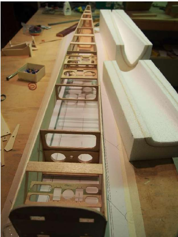
Rumpfaufbau 6: Bild 1, Einkleben von Brettchen (Reststücke einer Fräsfahne) zum Anpassen an Sandwich Rumpfdecken.
