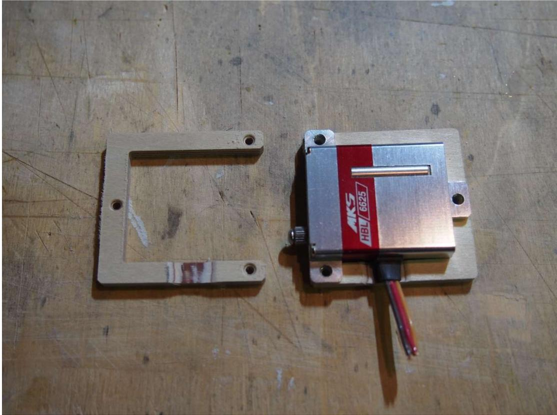
Bildfolge Aufbau Flügel 1: Bild 6, An der Stelle des Kabels den Rahmen 344 ausfräsen
