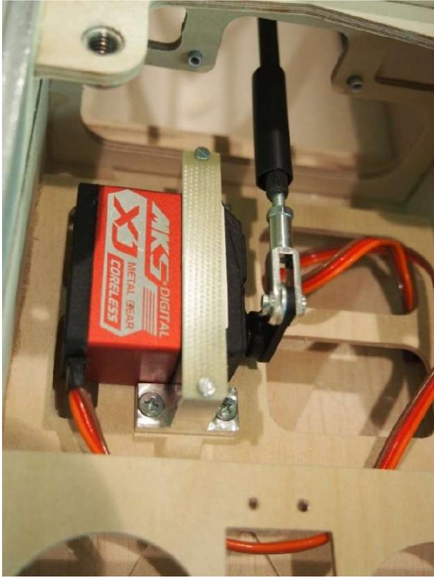
Bildfolge Höhenruder Anlenkung: Bild 7, Servo Einbau
