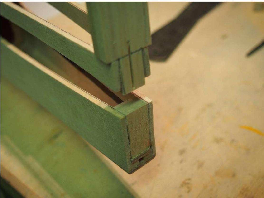
Bildfolge Ausrichten/Einkleben der Leitwerke 1: Bild 2
