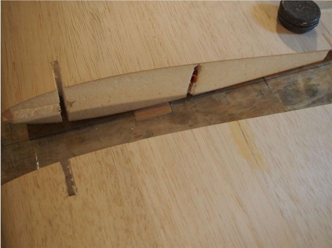
Bildfolge Aufbau Flügel 2: Bild 3, Unterlegen der V-Form Abstandslehre 315
