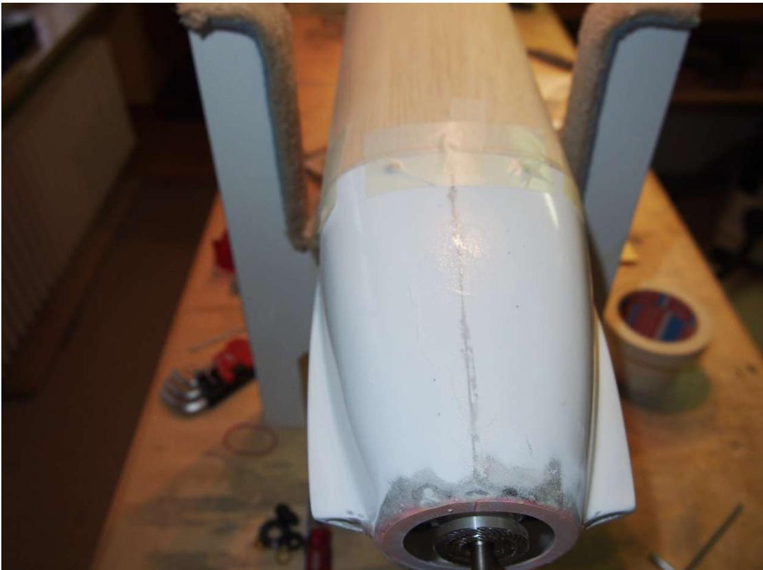
Bildfolge Motoreinbau/Motorhaube 2: Bild 5, der vordere Bereich der Haube kann aufgrund der Harz Aufdickung verschliffen werden.
