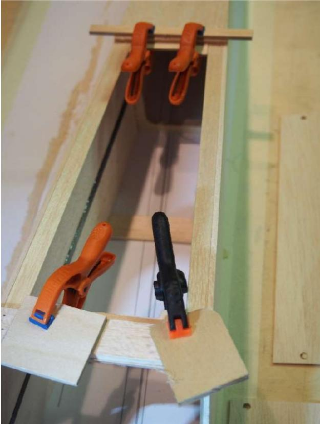
Rumpfaufbau 5: Bild 2, Einkleben der Auflagen 146, 147 für hinteren Rumpfdeckel
