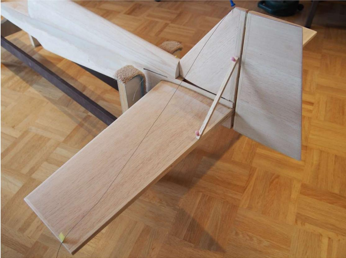
Bildfolge Ausrichten/Einkleben der Leitwerke 1: Bild 3
