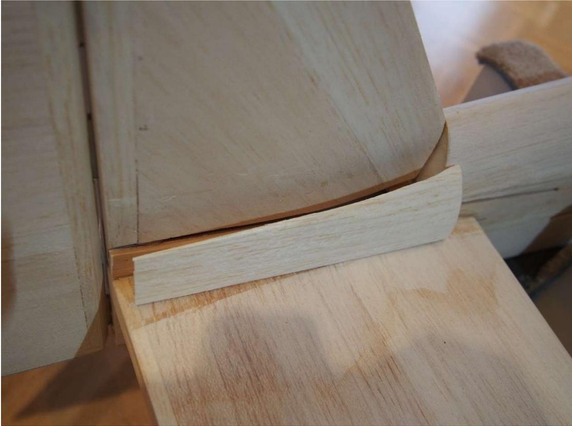
Bildfolge Ausrichten/Einkleben der Leitwerke 1: Bild 5
