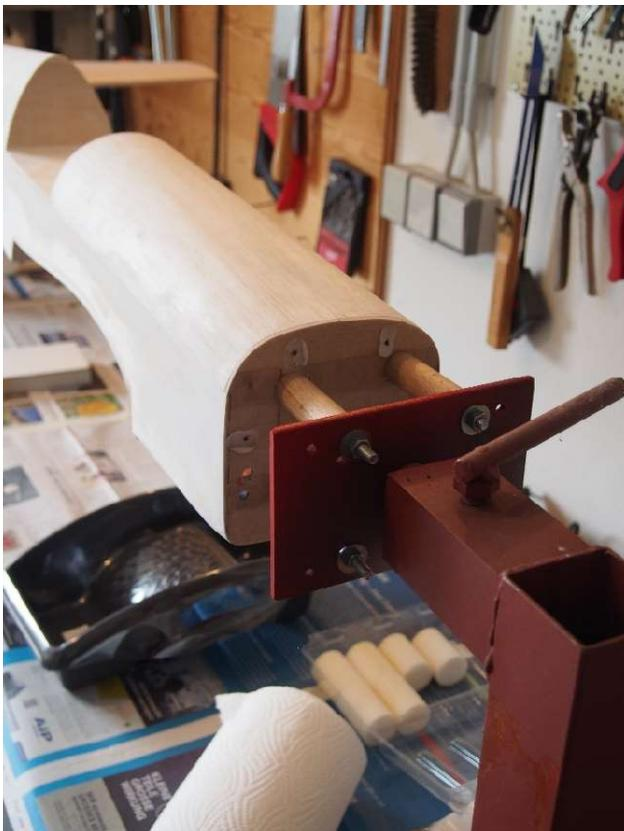
Bildfolge Finish / Folie: Bild 3, Aufnahme des Rumpfes zum Überziehen mit Gewebe/Gelcoat
