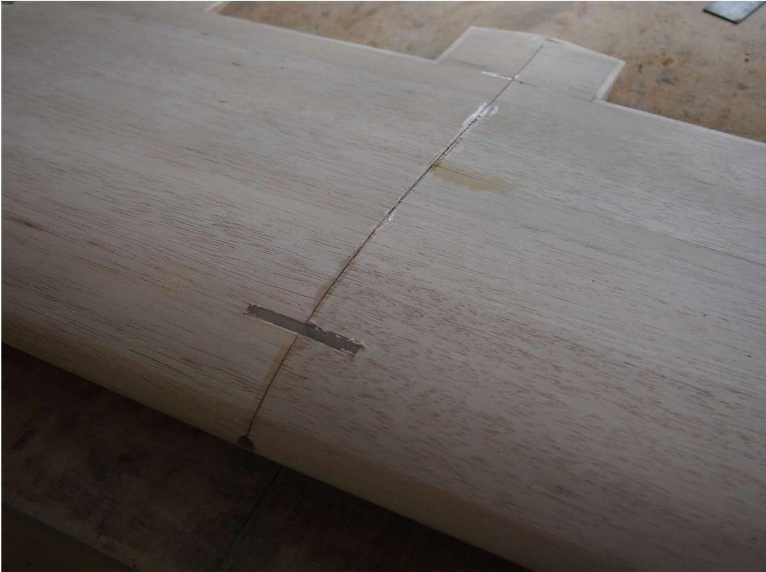
Bildfolge Aufbau Flügel 3: Bild 4, Flügelhälften zunächst stumpf miteinander verkleben, dann Halteplatte 302 einschieben und mit Gewebe überziehen.
