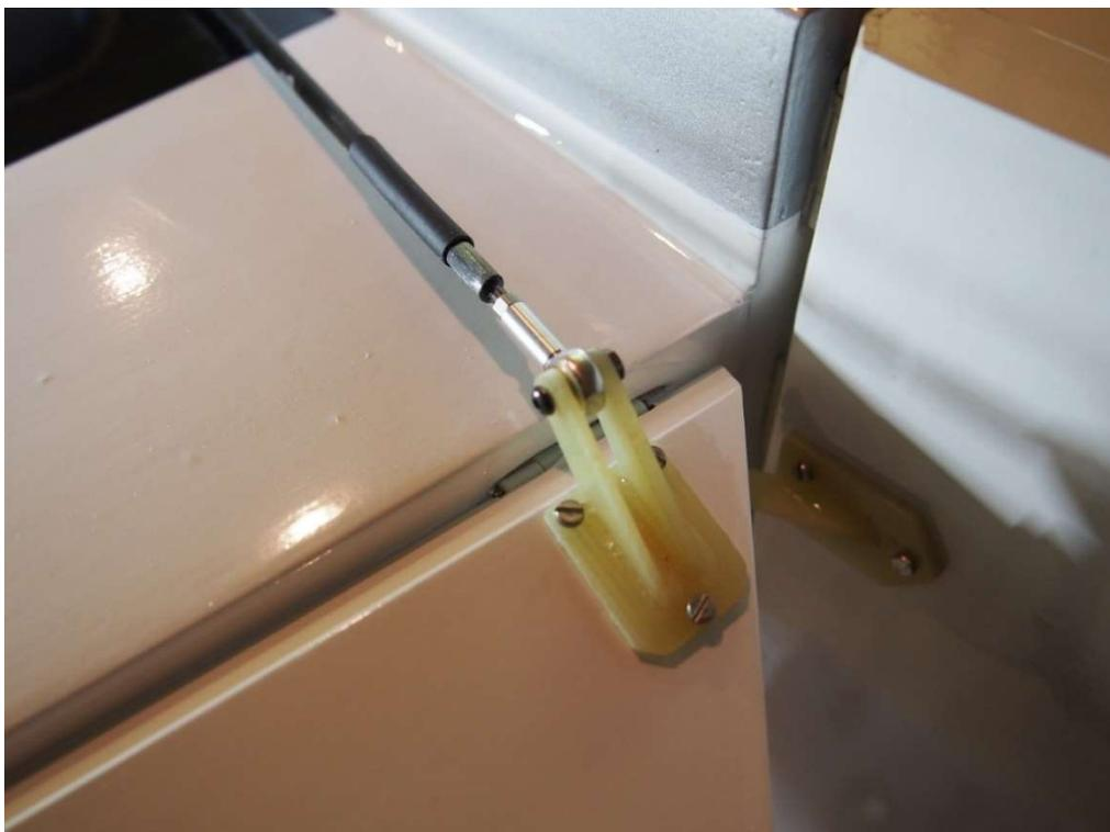
Bildfolge Höhenruder Anlenkung: Bild 6, Schrumpfschlauch ist noch nicht platziert und geschrumpft. Das innere Scharnier liegt direkt unter dem Ruderhorn.
