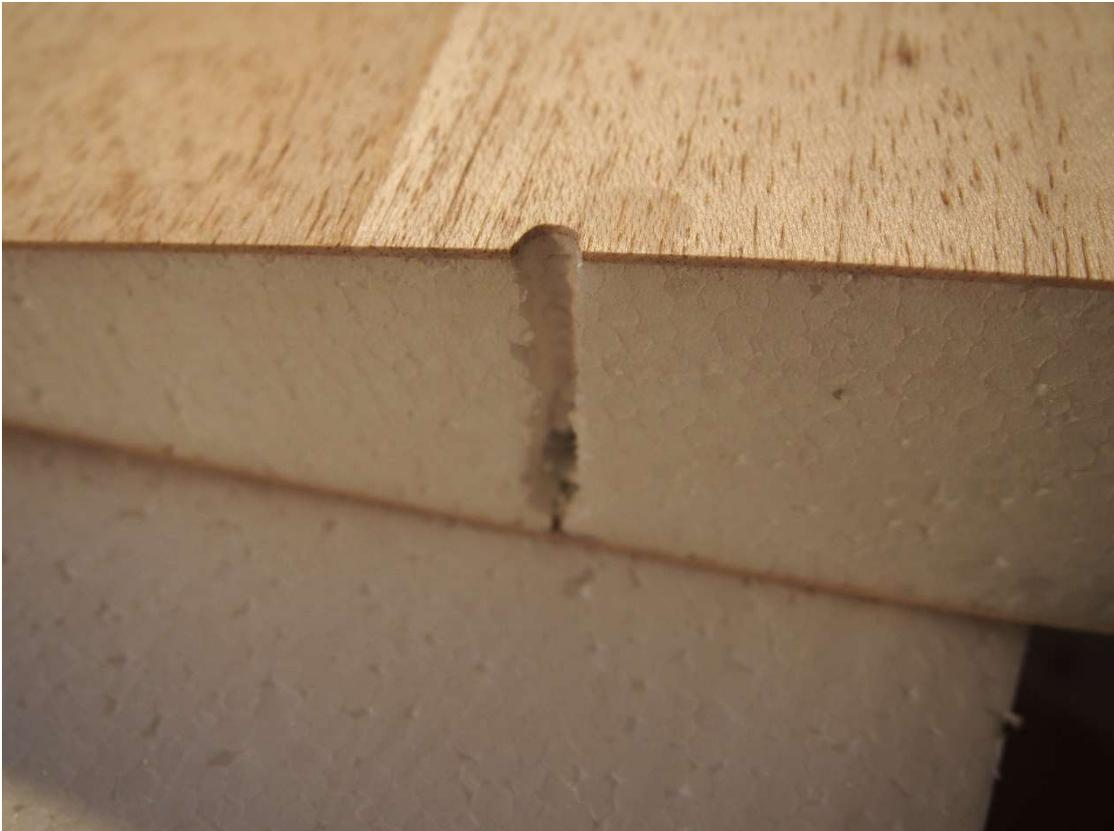
Bildfolge Aufbau Flügel 1: Bild 5, Kabelkanal in der Flügelwurzel
