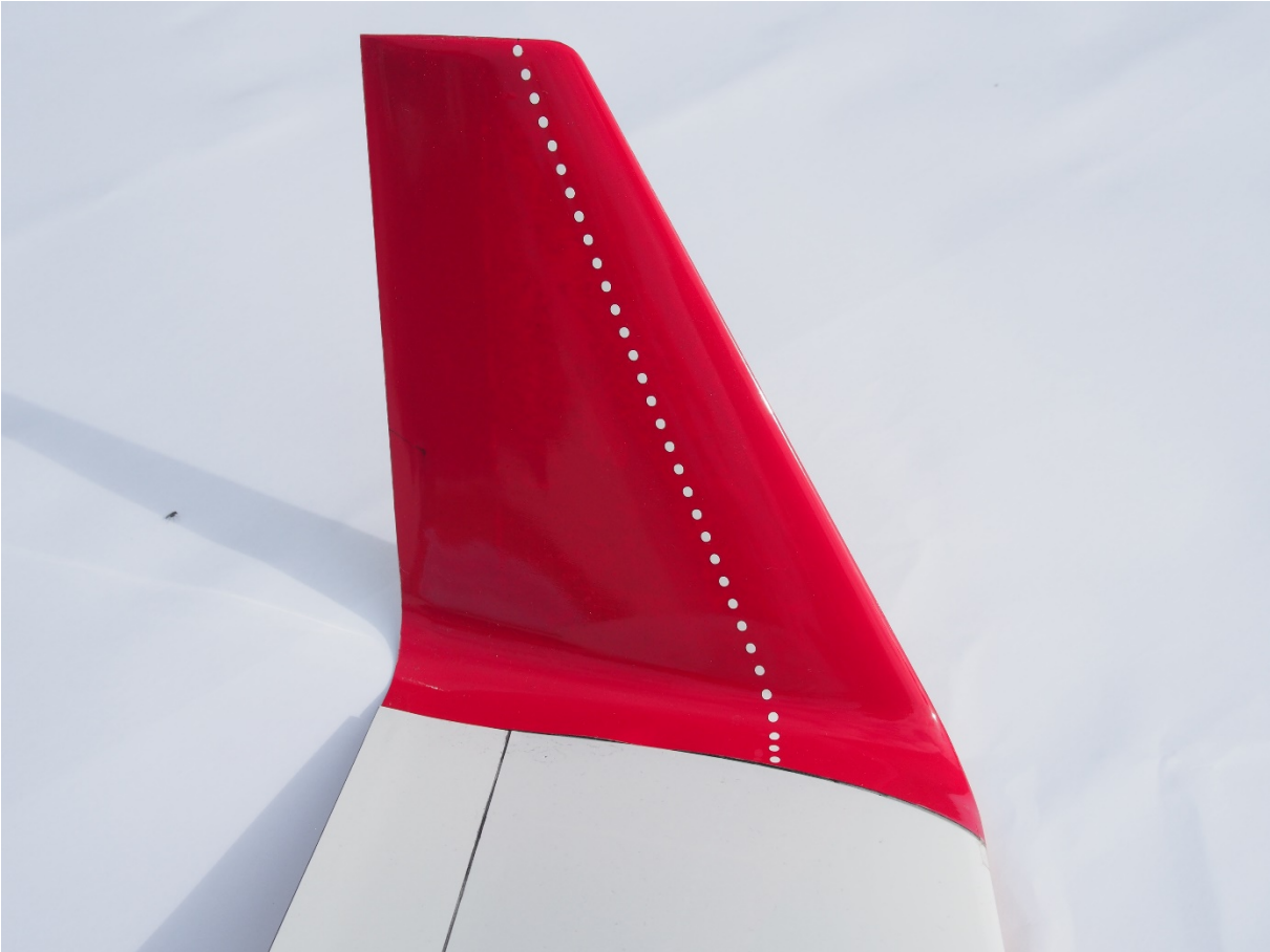
BILD 6-2. Kreisförmige Turbulatoren mit 0.15 mm Dicke
