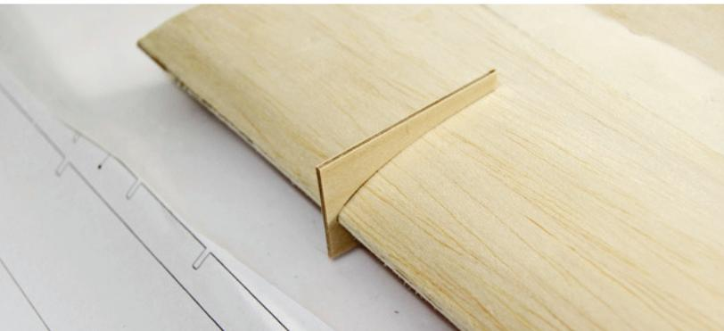
Sogar an Schablonen zur Kontrolle des korrekten Nasenradius hat der Hersteller gedacht. Die Konstruktion des Modells lässt aber auch an dieser Stelle kaum Raum für Baufehler.
