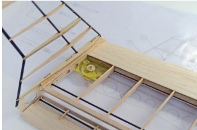
Stecker und Buchse versehene Verlängerungskabel verwendet, um mir beim Servoeinbau die Lötarbeiten zu sparen. Beim Aufkleben der unteren Beplankung habe ich das Trägerbrettchen an der Flächennase und die Rippen mit Holzleim bestrichen. Die Verbindung zum Holmgurt übernimmt auch hier 5-Minuten-Epoxi. Die Beplankung wurde dann bis zum Aushärten des Klebers mit Nadeln fixiert und am Holm mit Gewichten in Position gehalten.
