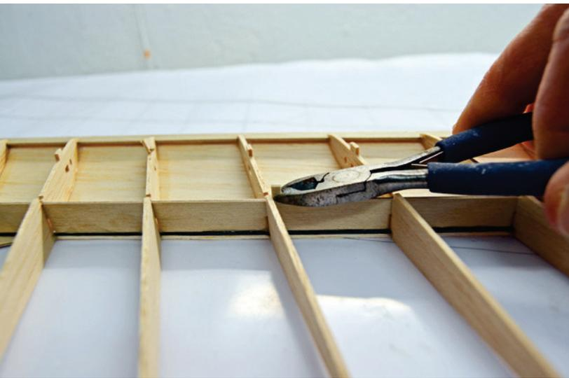
Die Füßchen auf der Unterseite der Tragfläche geben V-Form und Schränkung vor. Nach dem Verkleben der oberen Beplankung können sie mit einem Seitenschneider entfernt werden.
