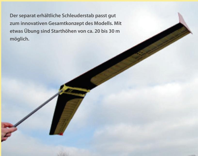
Der separat erhältliche Schleuderstab passt gut zum innovativen Gesamtkonzept des Modells. Mit etwas Übung sind Starthöhen von ca. 20 bis 30 m möglich.
